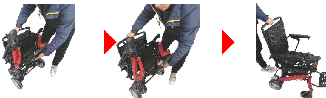
Imagens com o passo a passo para desdobrar a cadeira de rodas
