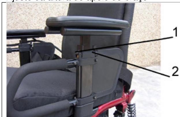
1 - Virando a alavanca para baixo remove o apoio do braço
